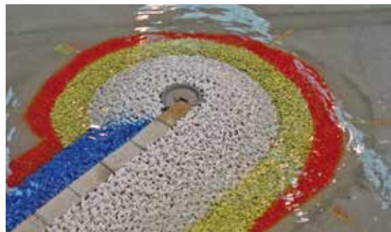
Vue d'un musoir pendant des essais 3D
