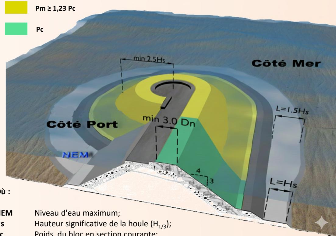
La transition entre deux tailles de blocs de carapace, dans ce cas présent entre le musoir et la partie courante, doit être construit selon un angle de 45° dans le plan de la sous-couche.
