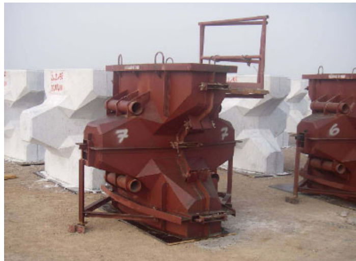
Photo No. 6: Coffrage ACCROPODE™ de petite taille
