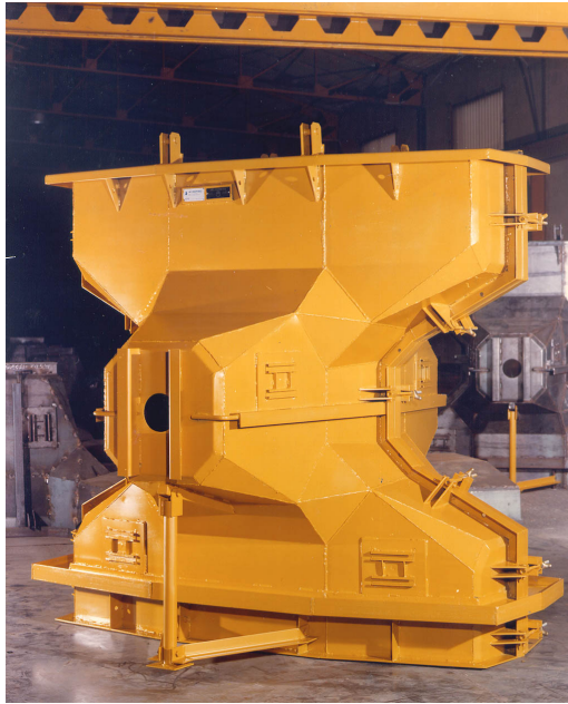
Photo No. 1: Vue d'un coffrage de 4 m 3 en atelier
