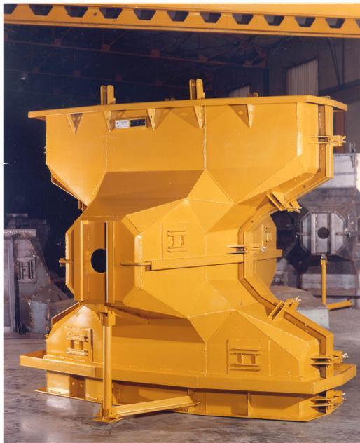
Photo No. 1: Vue d'un coffrage de 4 m<sup>3</sup> en atelier
