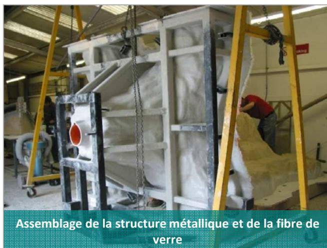
Assemblage de la structure métallique et de la fibre de verre
