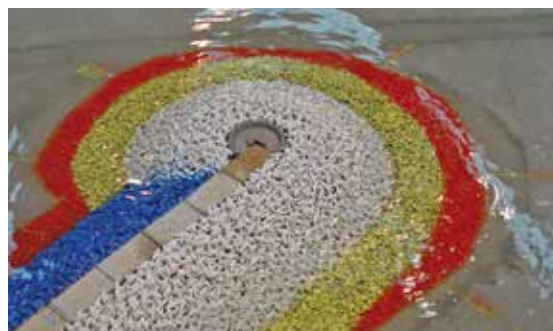
Vue d'un musoir pendant des essais 3D
