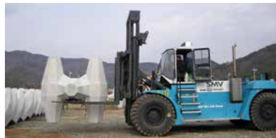
Manutention d'un bloc de taille moyenne à l'aide d'un chariot élévateur
